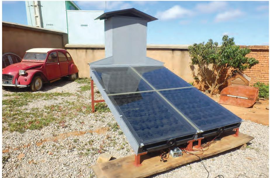
Die ersten Tests des neuen Dörrapparats für Feuchtgebiete ermöglichten das Trocknen von etwa fünfzig Kilogramm Bananen (Foto; T. Lehmann / CEAS)
